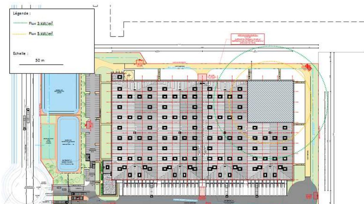
Figure 8 - Cartographie des flux thermiques – stockage d'aérosols – projet VIRTUO FOS 2
